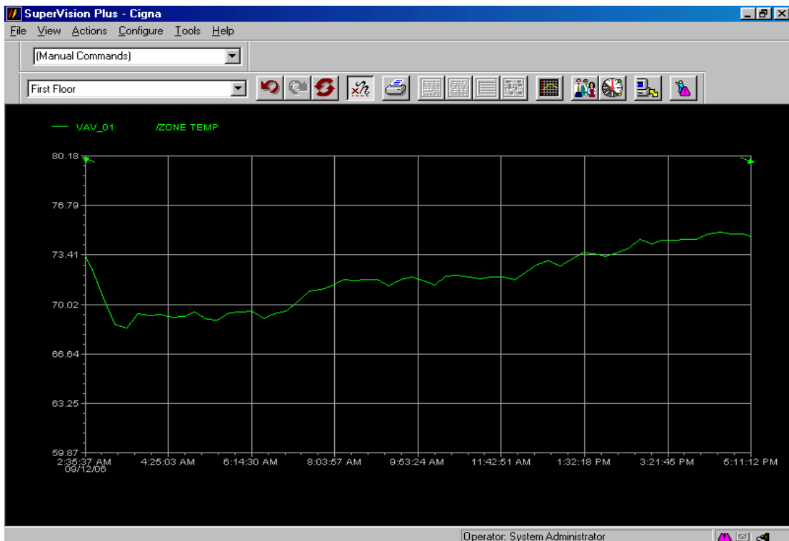
图 3.9 指数型室内设定温度重置策略下的回风温度变化-CHCCC
